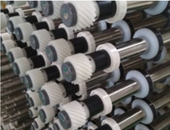
GB 轴承应用于半导体设备转动机构
